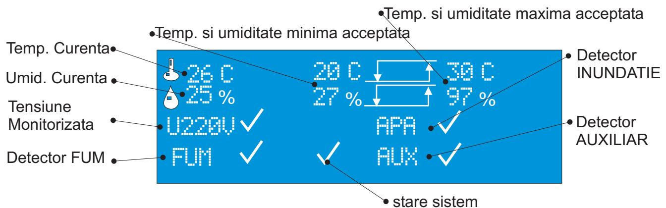
La aparitia unui eveniment (cauzat de una din intrari) va fi afisat semnul X in dreptul intrarii respective, si semnul de stare sistem va deveni alarmata (LOUDSPEAKER). De asemenei, intrarea respectiva va palpai.
